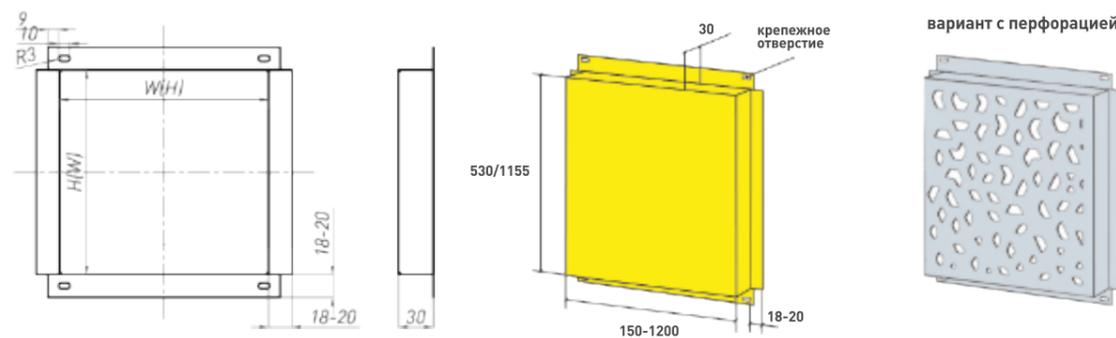
**ФКС 30 мм** - фасадная кассета для наружной отделки угловая
