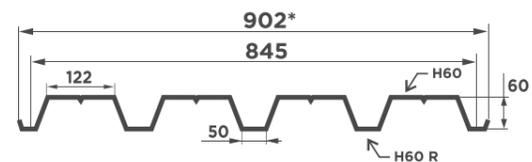
Для профнастила Н-60 рекомендуемый угол наклона кровли от 8°
