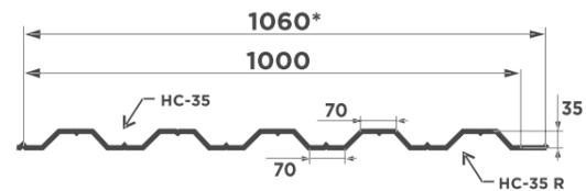
Для профнастила НС-35R рекомендуемый угол наклона кровли от 12°
