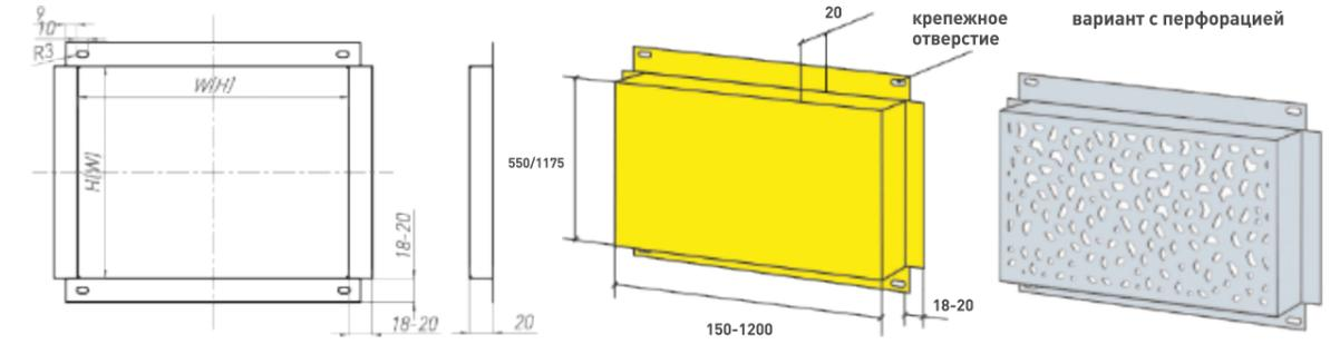
**КВО 20 мм** - фасадная кассета для внутренней отделки угловая
