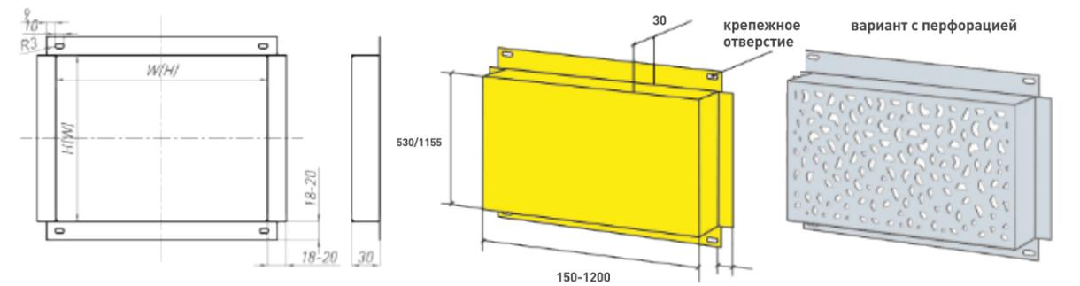
**КВО 30 мм** - фасадная кассета для внутренней отделки угловая
