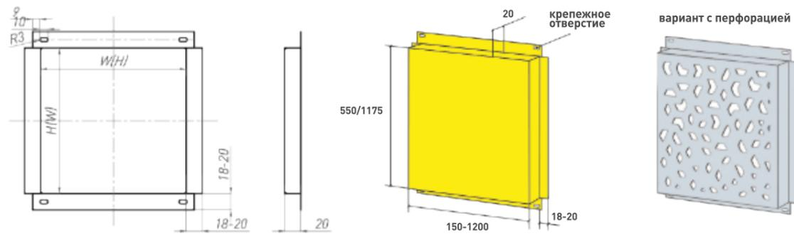
**ФКС 20 мм** - фасадная кассета для наружной отделки угловая
