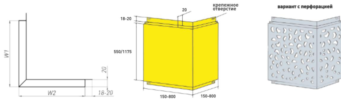
**ФКС 30 мм** - фасадная кассета для наружной отделки стен
