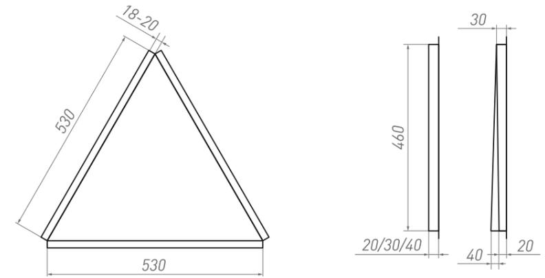
Возможно изготовление металлокассеты с 3 размерами подъёма
