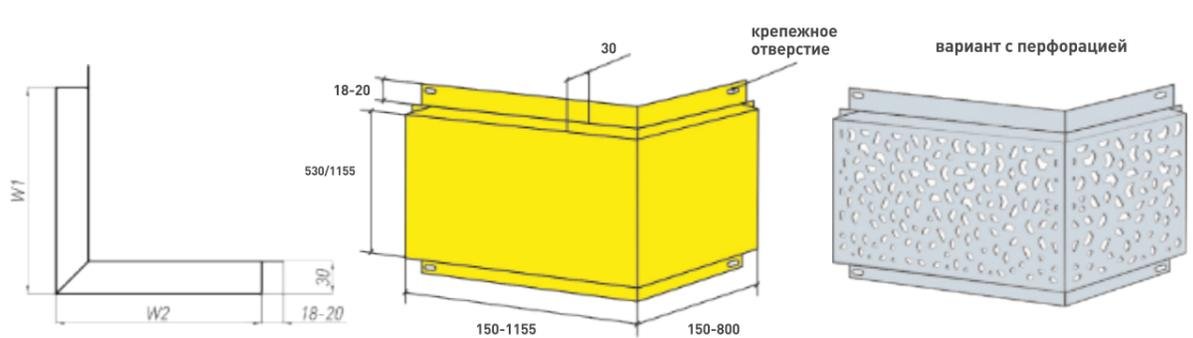
**ФКП 20 мм** - фасадная кассета для наружной отделки П-образная
