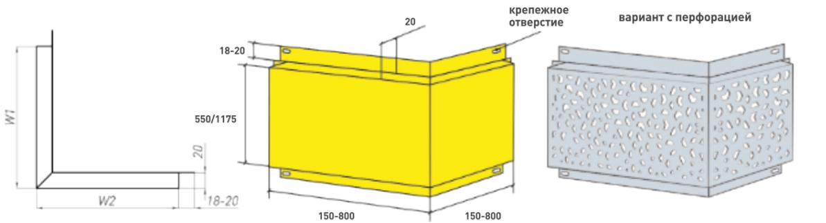
**КВО 30 мм** - фасадная кассета для внутренней отделки стен
