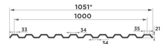
Для профнастила С-21 рекомендуемый угол наклона кровли от 15°
