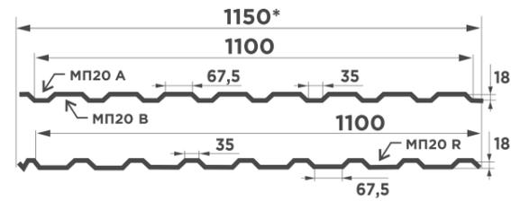
Для профнастила МП-20R рекомендуемый угол наклона кровли от 15°
