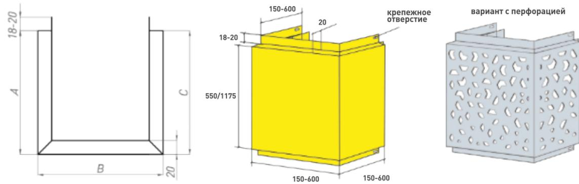
**ФКП 30 мм** - фасадная кассета для наружной отделки П-образная
