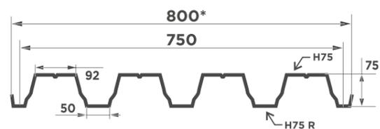
Для профнастила Н-75R рекомендуемый угол наклона кровли от 8°
