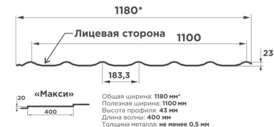
**Металлочерепица «Макси»** сочетает в себе изящность главных обводов классической натуральной черепицы, надёжность защищенной полимерным покрытием стали нестандартные пропорции волны, благодаря которым любое здание приобретает законченный вид.
